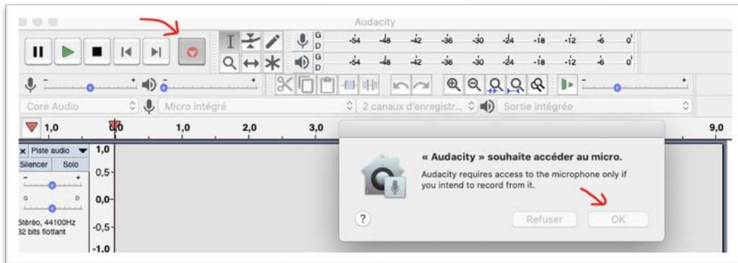
3. Ajuster le volume du micro pour que l'indicateur de niveau ne dépasse pas -12.5db
